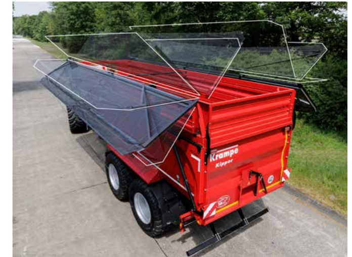
Das zweiseitige, hydraulische Krampe TwinTop Verdeck öffnet und schließt sich in nur ca. 15 Sekunden und lässt sich bequem von der Fahrerkabine aus steuern.
