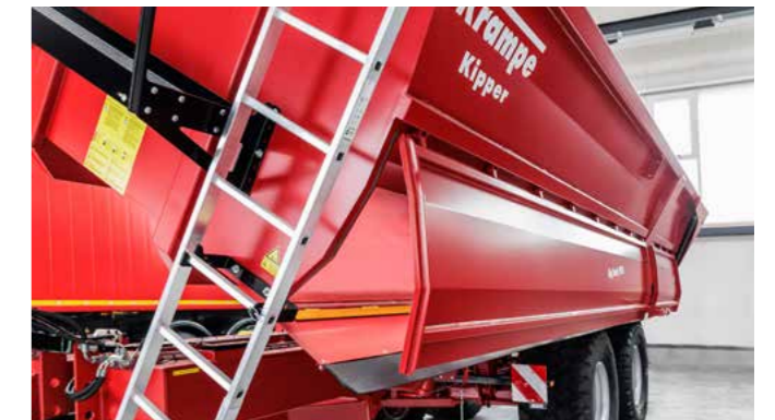
Die seitlichen Bordwände werden auf ganzer Länge mit einer Anpresslippe korndicht abgedichtet. Auf der Entriegelungswelle sind die Anpressleiste und das serienmäßige Ablaufblech montiert.
