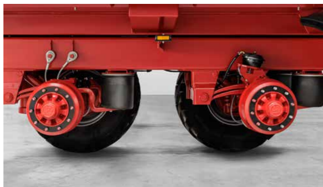
Luftgedernte Fahrwerke sind im Trend und werden bereits serienmäßig angeboten. Die gekröpten Zweiblattlenker und großen Luftfederbälge sorgen für Laufruhe und stabiles Fahrverhalten. Beim Kippen senkt sich das Fahrzeug durch das Entlüften der Bälge automatisch ab, was die Standsicherheit erhöht.
