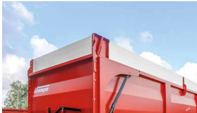
Extra leichte Silageaufsätze aus Aluminium gibt es in 40 cm Bauhöhe.
