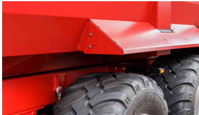
Serienmäßig geschraubte, in der Breite verstellbare Kotflügel mit sehr steilem Anstellwinkel, auf denen kein Ladegut haften bleibt.
