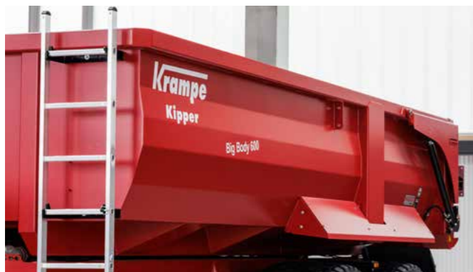
Für niedrige Hallen oder empfindliche Transportgüter wie Kartoffeln kann die Wannenhöhe auf 1,00 Meter verringert werden.
