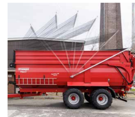
Die seitlich schwenkbaren Alu-Bügel öffnen und schließen die Netzabdeckung.
