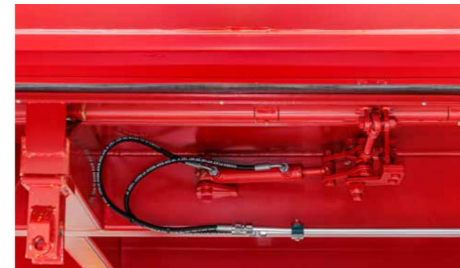
Die hydraulische Entriegelung der seitlichen Bordwände kann bequem vom Schleppersitz aus erfolgen. Der Übertotpunkt-Verschluss sichert gegen unbeabsichtigtes Öffnen.
