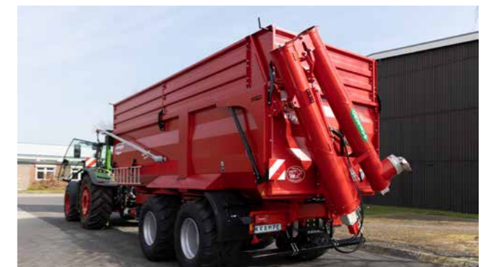
Leistungsstarke Überladeschnecken mit seitlicher Abgabe und Leistungen von 20 bis 350 t/h.
