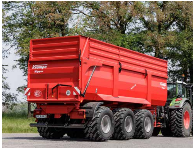
Silageaufsätze gibt es aus Stahlprofilbordwänden mit 60 oder 80cm Bauhöhe.
