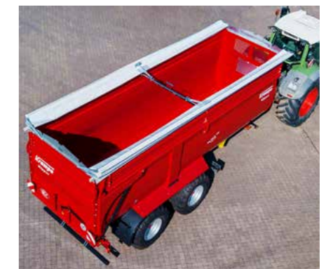
Das Fliptop Abdecksystem öffnet und schließt sich hydraulisch zu beiden Fahrzeugseiten.
