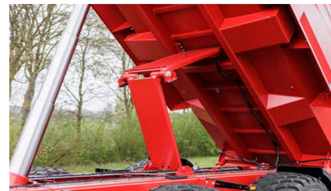
Unser Scheren-Stabilisator minimiert Verwindungen zwischen Fahrgestell und Aufbau beim Kippvorgang und gehört zur Serienausstattung des BigBody 980.
