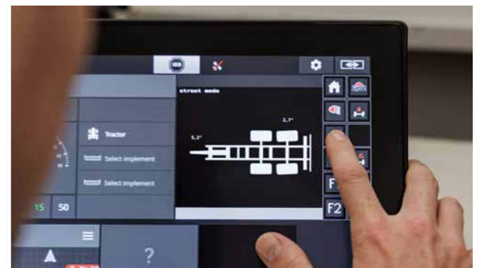
Mittels ISOBUS-Steuerung haben wir die Bedienung über das Terminal der Zugmaschine für die Zwangslenkung realisiert.
