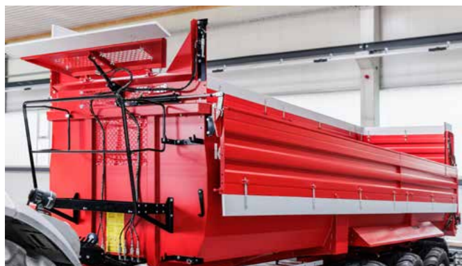
Die seitlich klappbaren Aufsatz-Bordwände können hydraulisch betätigt werden.
