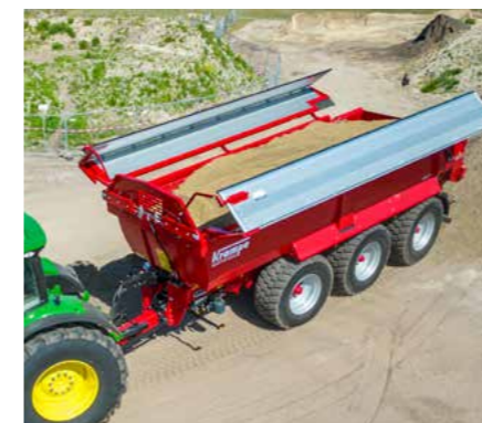
Das hochwertige Aluminiumklappverdeck lässt sich in nur ca. 20 Sekunden öffnen und schließen und ist bis zu einer Länge von 9,0 m verfügbar.
