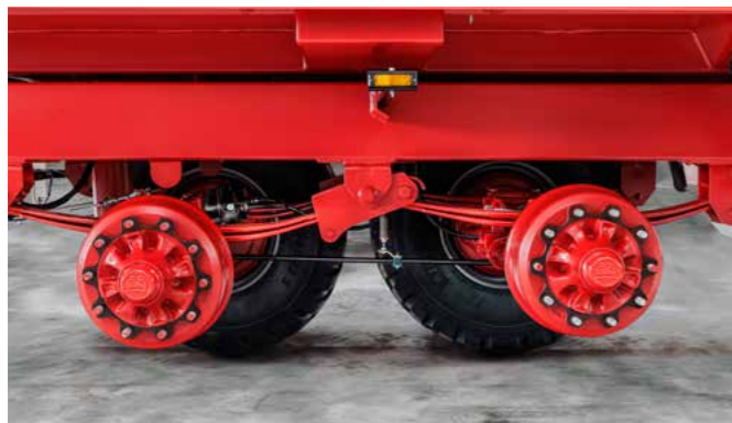
Die standardmäßig beim BigBody 500 und 540 verbauten 20 t Parabelfedern garantieren eine große Bodenfreiheit.
