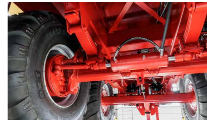
BPW Nachlauflenkung: Ausführung mit Wellendruckscheibe für ein ruhiges Fahrverhalten. Die Lenkachse muss bei Straßenfahrten hydraulisch gesperrt werden.
