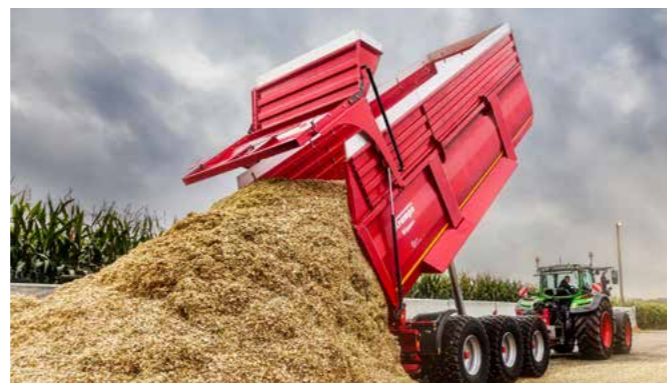
Die 80 cm hohen Stahlaufsätze können um weitere 20 cm Aluminiumaufsätze erweitert werden.
