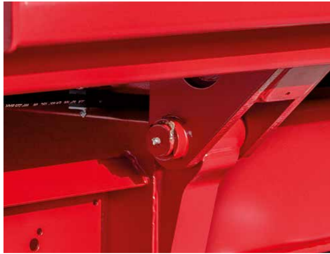
Die schweren Faust-Kipplager mit auswechselbaren Messingbuchsen sind spielfrei gelagert. Die Tridem-Fahrzeuge haben serienmäßig Kugelkipplager.
