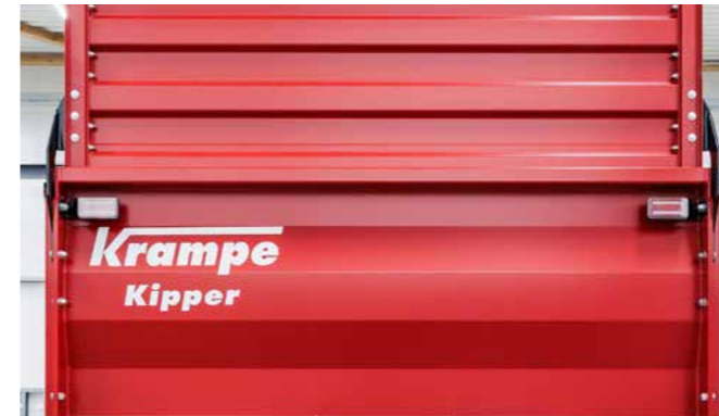
Optional sind zusätzliche LED-Rückleuchten oben in der Heckklappe verfügbar.
