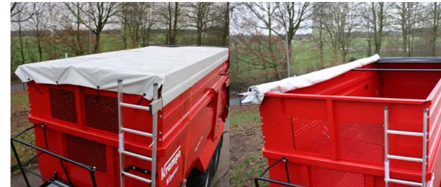
Wickelplanen sind ein einfaches, aber bewährtes System zur Ladungssicherung. Durch das Wickelbrett kann die Plane schnell und einfach manuell aufgerollt und gesichert werden.
