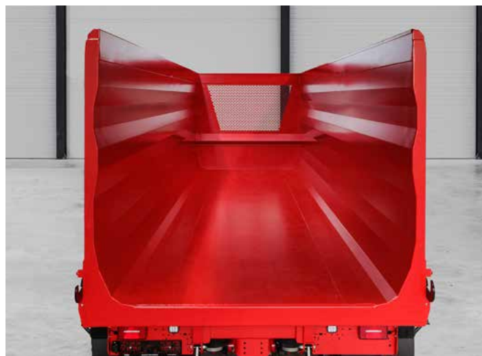
2 m hohe Wannenkonstruktion – korndicht und stabil.
