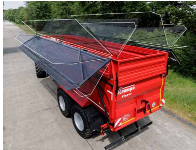
Das zweiseitige, hydraulische Krampe TwinTop Verdeck öffnet und schließt sich in nur ca. 15 Sekunden und lässt sich bequem von der Fahrerkabine aus steuern.
