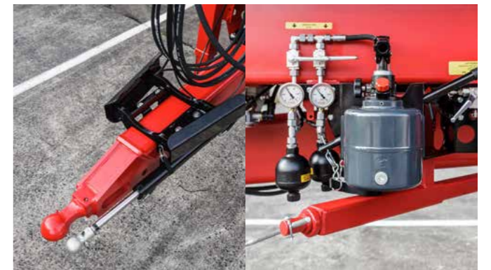
BPW Zwangslenkung: dw-Geberzylinder befindet sich vorne an der Zugvorrichtung, Fahrtrichtung links & rechts beim Tridem, hydr. Anlage komplett mit Handpumpe, Manometern und Stickstoffspeichern, Kopplungspunkte am Schlepper nach dem Normvorschlag (ISO 26 402)
