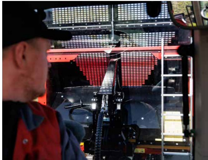
Durch die großflächige Gitteroptik der Schubwand hat der Fahrer immer einen guten Blick auf die Ladung.
