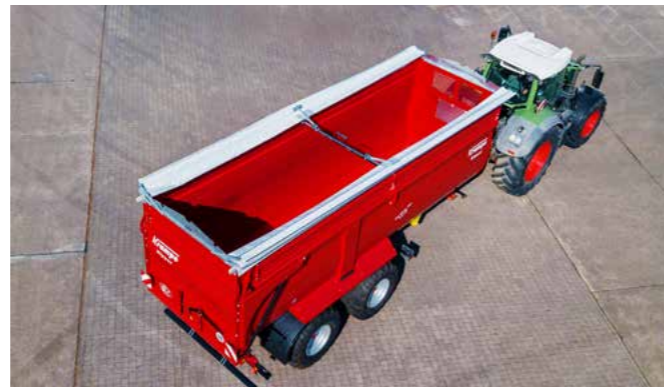
Das Fliptop Abdecksystem öffnet und schließt sich hydraulisch zu beiden Fahrzeugseiten.
