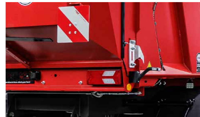
Beleuchtung mit 5 Kammer LED Rückleuchten ist in der Heckklappe integriert.
