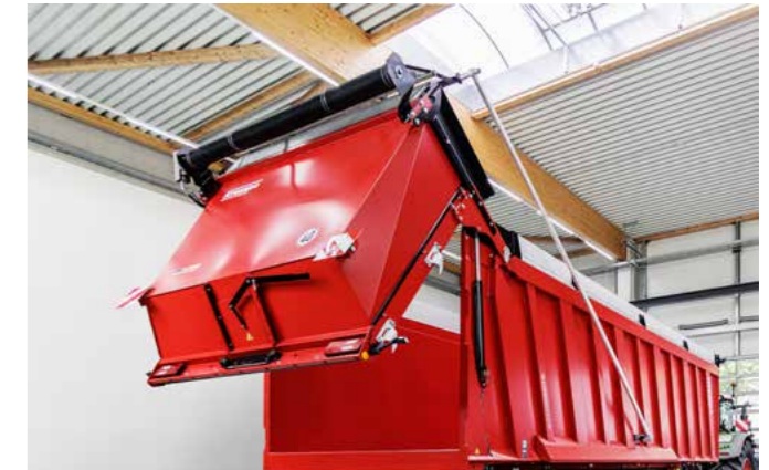
Mit der Volumenheckklappe erhöhen Sie das Transportvolumen um 2,5 m 3 . Serienmäßig ist dann ein hydraulisch klappbarer Unterfahrerschutz montiert.
