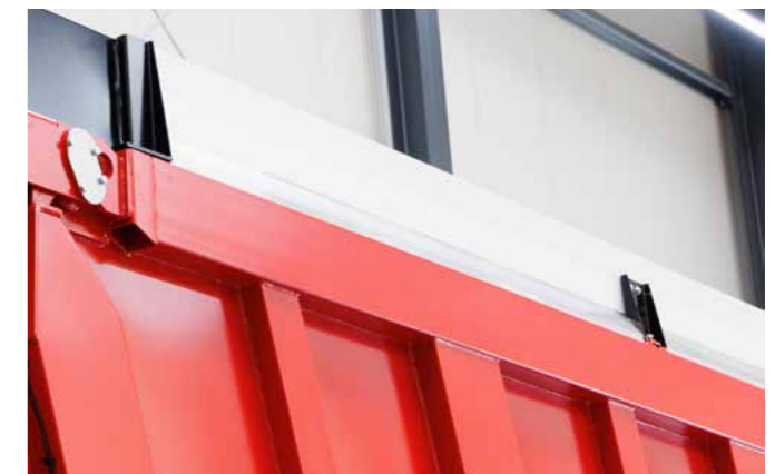
Serienmäßig ist eine Ablaufschräge am Aufsatz verbaut. So wird keine Ablagefläche für Silage geboten und aufwendiges Reinigen für die Straßenfahrt entfällt.
