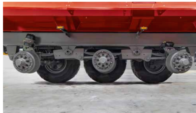
Beim RamBody 900 verwenden wir 36 t Parabelfedern mit Längslenkern und dynamischem Achsausgleich im Achsabstand von 1,55 m.
