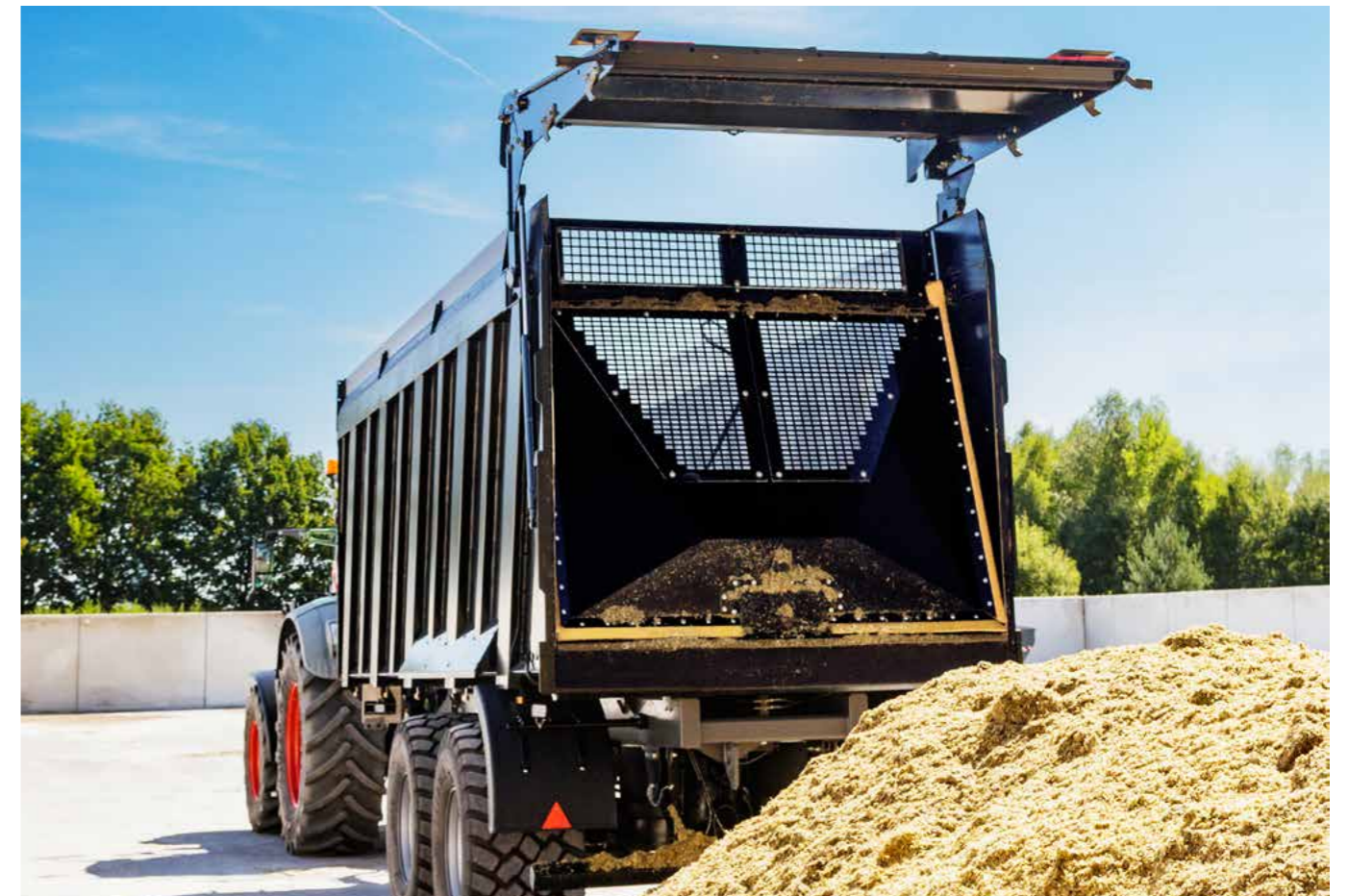
Unser RamBody 750 entlädt 40 m 3 Silomais in nur ca. 45 Sekunden bei 100 l/Minute.
