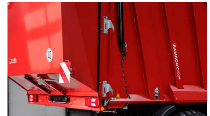
Heckklappenführung mit vier Verriegelungskeilen. Verstellbar und dadurch auch nach vielen Jahren im Einsatz dicht.
