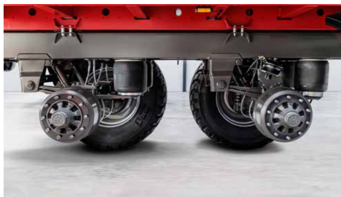
Luftgefederte Fahrwerke sind im Trend und werden auf Wunsch verbaut. Die Zweiblattlenker und die großen Luftfederbälge sorgen für Laufruhe und stabiles Fahrverhalten.
