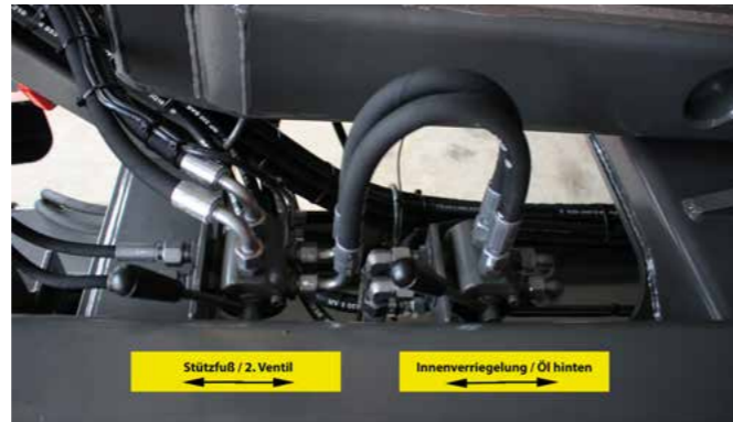
Mit dem 6/2-Wegeventil können zwei hydraulische Funktionen mit einem Steuergerät bedient werden.
