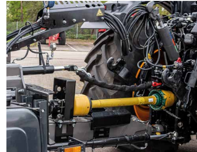
Der Topzug-Zylinder kann beim Aufziehen von schweren Containern sinnvoll sein.
