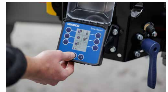
EBS-Anlage zur elektronischen Steuerung der pneumatischen Bremsanlage mit lastabhängiger Bremse (ALB), Anti-Blockier-System (ABS) und Roll Stability Support (RSS), eine elektronische Stabilitätsregelung ist serienmäßig in das System integriert. Optional können weitere Funktionen der Luftfederung gesteuert werden.
