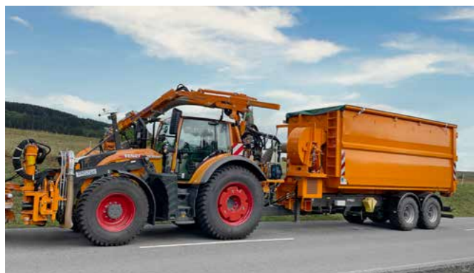
Volumencontainer mit Einblasöffnung für den Transport von Grasnähen, welcher von der Straßenbankette gemäht und anschließend abgesaugt wird.
