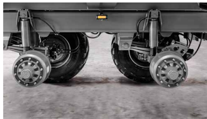
Auch Krampe liefert hydraulische Fahrwerke. Die serienmäßigen Schutzrohre verhindern Steinschlag auf den doppelt-verchromten Kolbenstangen.
