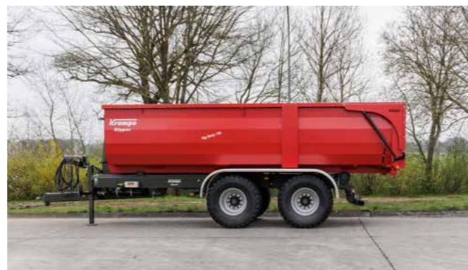
Der THL 21 L mit serienmäßigem Luftfahrwerk kann auf Wunsch mit einer Lenkachse und einem Achsabstand von 1,81 m für 24 t zulässiges Gesamtgewicht bei 40 km/h geliefert werden. Für dieses Modell sind viele weitere Sonderausstattungen verfügbar.
