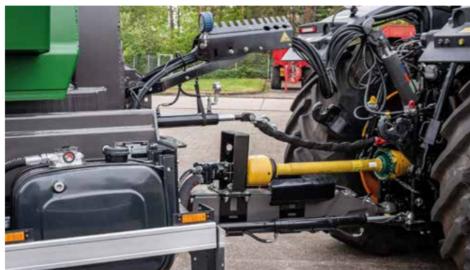
Für alle Abrollkipper bis 25t Hubkraft reicht die Schlepperhydraulik (200bar) aus. Eine eigene Ölversorgung mit Zapfwelle ist auf Wunsch lieferbar. Im Lieferumfang ist eine Funk-Fernbedienung enthalten.
