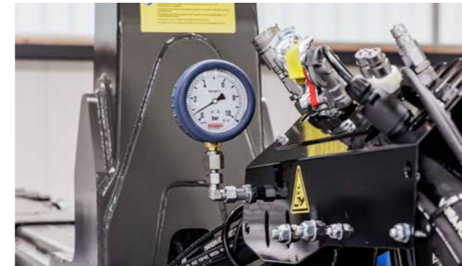
Balgdruckmanometer zur Anzeige des Luftdrucks in den Luftfederbälgen des Fahrwerkes.
