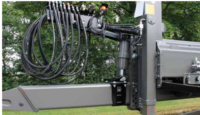
Die Zugvorrichtungen gibt es höhenverstellbar, mit Gummisilentblock oder Hydraulikzylinder.
