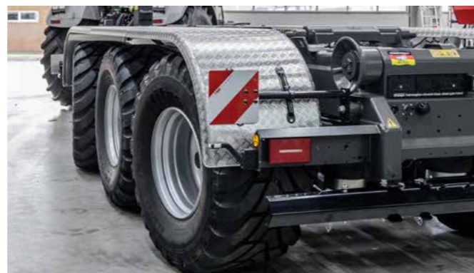
Serienmäßig werden unsere Tridemhakenliftanhänger mit einer Nachlaufenkachse gebaut, zu empfehlen ist aber eine Zwangslenkung.
