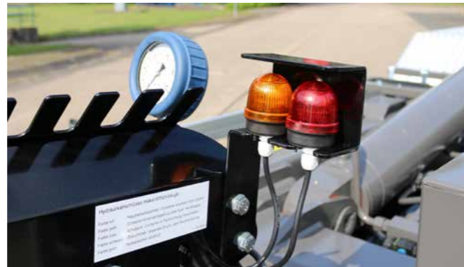
Ab der Baureihe THL 16-L werden unsere Hakenliftanhänger Serienmäßig mit Kontrollleuchten ausgestattet. Bei einer Funksteuerung werden die Kontrollleuchten durch eine digitale Anzeige ersetzt.
