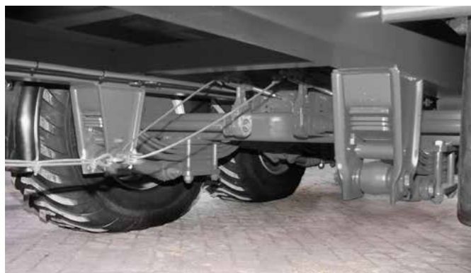
Exportversion: Bei der Ausführung mit Parabelfedern und hängenden Achsen ist die Bauhöhe sehr niedrig. Eine hydraulische Hinterachsabstützung entlastet die Zugmaschine beim Aufziehvorgang.
