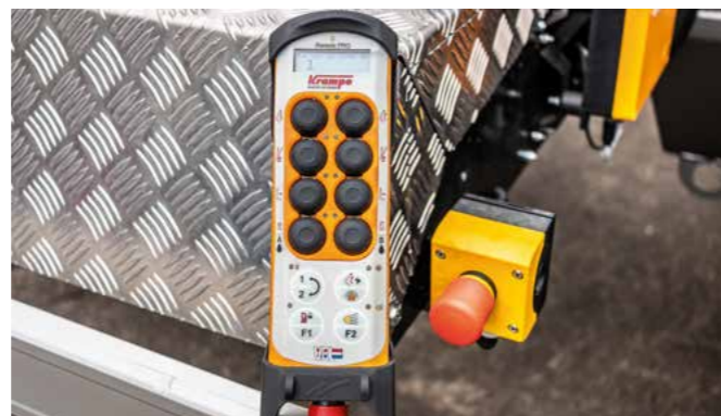
Mit der Funk-Fernbedienung können die Hauptarbeitszylinder, der Schubarm und die hydraulische Containerverriegelung bedient werden. Weitere Funktionen sind verfügbar.
