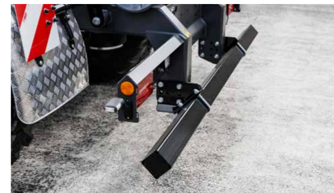
Starrer Unterfahrschutz mit COC Abnahme bei der 40 km/h Version.
