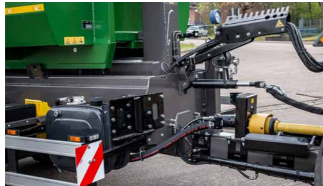
Der THL 30 L ist von Haus aus mit einer eigenen Ölversorgung und einer Funk-Fernbedienung ausgerüstet. Container mit 30t Eigengewicht können so sicher aufgenommen und auch gekippt werden.
