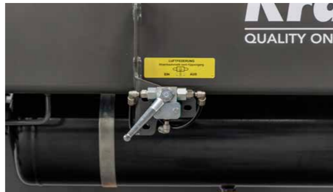
Die Luftfederung ist serienmäßig mit einem Umschalhahn ausgerüstet. Dieser kann das Absinken des Fahrwerkes beim Kippvorgang verhindern.
