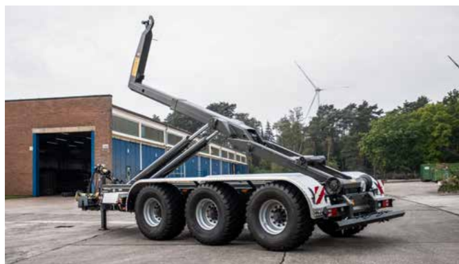
Serienmäßig ist der THL Tridem ausgelegt für Containerlänge von 6,5 m bis 7,0 m.
