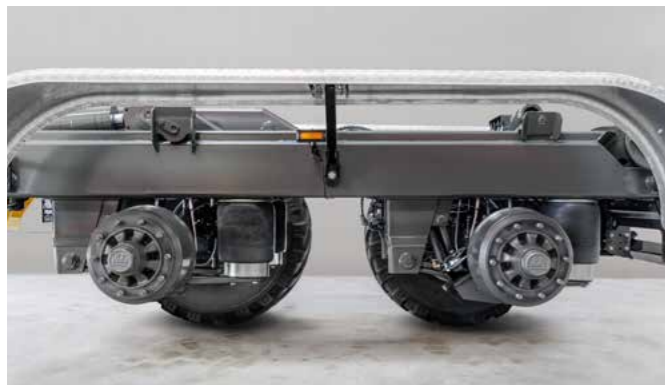
Das Luftfahrwerk ist ausgerüstet mit Zweiblattlenker und Luftbälge mit einem Durchmesser von 360 mm. Diese Kombination sorgt für ein extrem gutes und stabiles Fahrverhalten.
