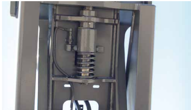
Bedienungsfehler ausgeschlossen! Ein Absetzen des Containers ist nur dann möglich, wenn der Schubarm vollständig eingezogen ist. Andernfalls wird der Absetzrahmen automatisch mit dem Kipprahmen verriegelt.
