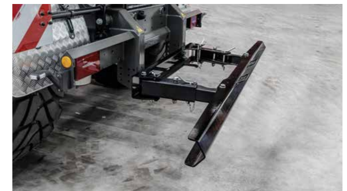
Der faltbare Unterfahrschutz (Nutzhub 50cm) lässt auch den Transport von Containern mit Überlänge zu.
