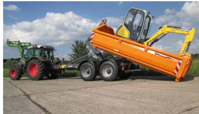
Container für den Transport von Baumaschinen mit integrierten Zurrösen und Heckklappe mit Doppelflügeltür
