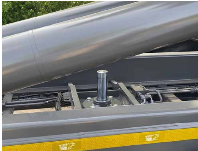
Der Ankipf-Hilfszylinder (Startzylinder) erleichtert das Kippen der Behälter im abgesenkten Zustand. Das ist besonders sinnvoll, wenn ein kurzer Überhang beim Kippen gewünscht wird.
