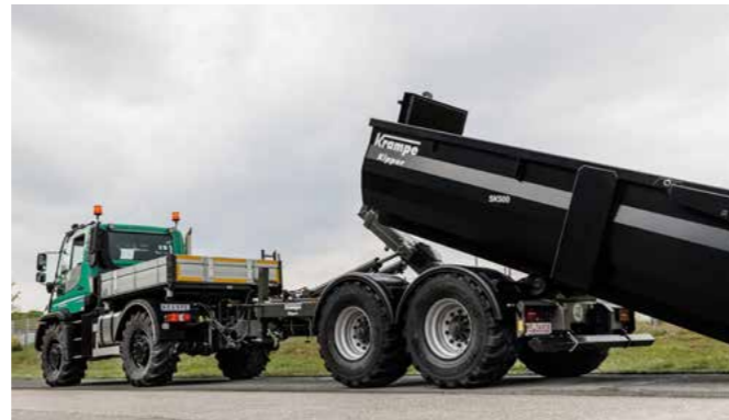
Der THL 11L ist das kompakte Fahrzeug für die Landwirtschaft mit einer Containerlänge von max. 5,0 Meter.
