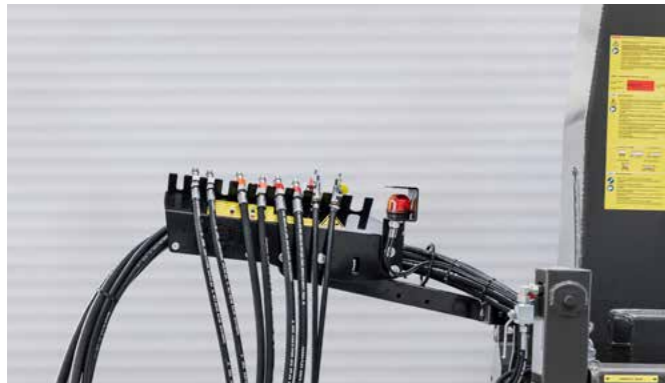
Bei dem THL 25 L wird die Schlepperhydraulik genutzt. Hier können Containergewichte von bis zu 25t aufgenommen und entladen werden. Ein Ankipp-Hilfszylinder wird serienmäßig verbaut.
