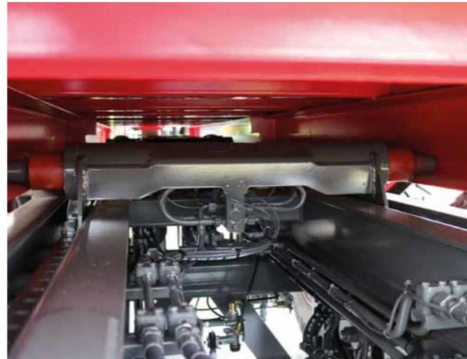
Eine hydraulische Containerverriegelung gehört zur Serienausstattung. Ganz wichtig: Damit können auch unterschiedlich lange Container in jeder Stellung fixiert werden.
