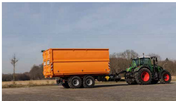
Containerlänge von 6,25 Meter Innen, beziehungsweise mit einem ausfaltbaren Unterfahrerschutz, von 6,75 Meter innen sind möglich.
