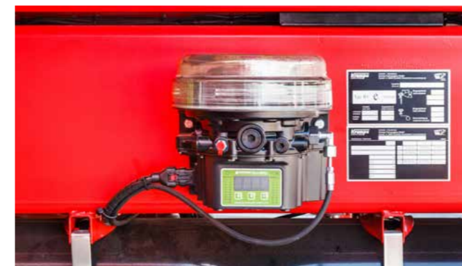
Mit der Zentralschmierung werden alle Schmierstellen automatisch mit Fett versorgt, auch an schwer zugänglichen Stellen.
