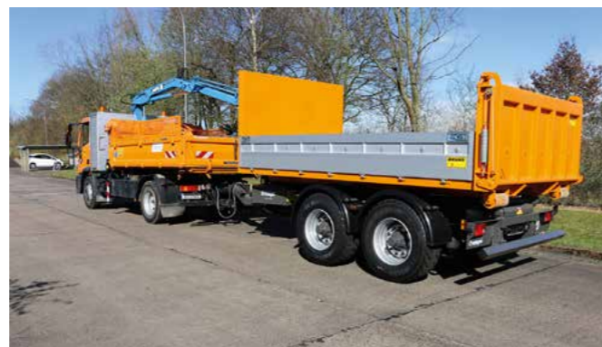
Kommunalcontainer mit seitlich abklappbaren Alubacken und überfahrbarer Pendelheckklappe.
