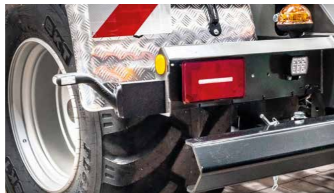
Die großen LED-Rückleuchten sind in einem massiven Schutzgehäuse untergebracht, seitliche Positionsleuchten im Heck dienen dem Fahrer zur besseren Übersicht.
