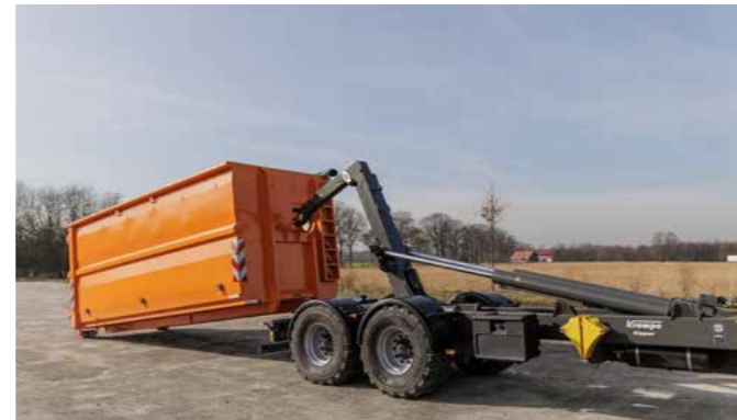
Durch den Verzicht auf einen zusätzlichen Hilfsrahmen verringert sich der Aufzugswinkel und die Aufzugsleistung steigt.
