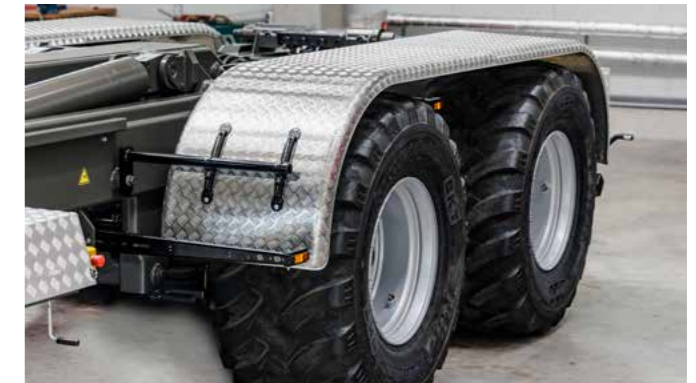
Alu-Kotflügel für Breitreifen und Lenkachsen.
